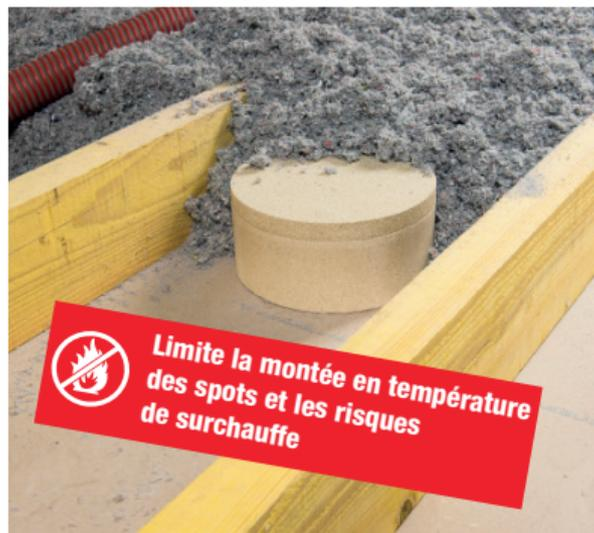
**THERMÉO SPOT** est un protecteur thermique pour éclairage encastré. Le protecteur de spot **Therméo Spot** est réalisé par moulage de **vermiculite** exfoliée et compressée. **Compatible avec tous les isolants**, il limite la **montée en température du spot**. Il est le seul compatible avec une isolation en vrac.
