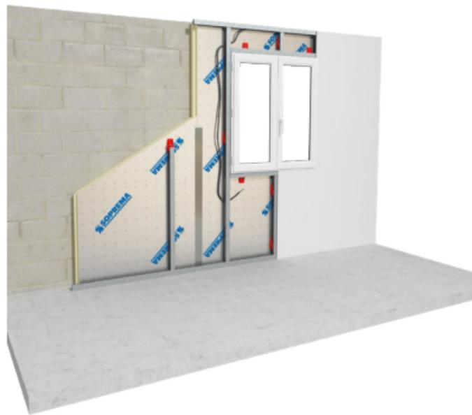
Le **PU haute réflexion** est un panneau constitué d'une mousse rigide de **polyuréthane** revêtu d'un parement **multicouche étanche** sur une face et d'un parement **multicouche étanche réfléchissant** sur l'autre face. Il est destiné à l'isolation des **murs par l'intérieur** à l'aide **d'un appui de contre-cloison**.
